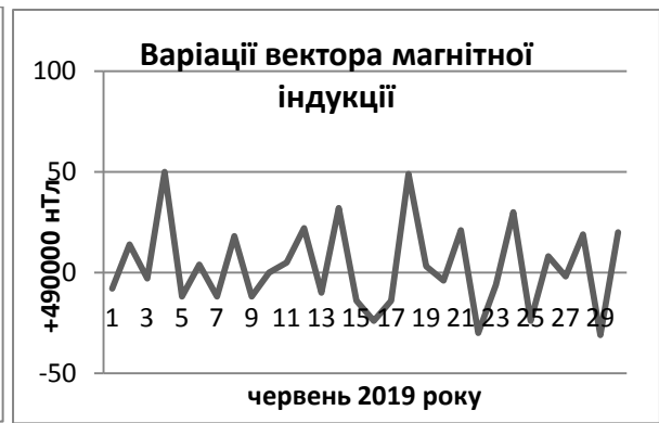
Рисунок 3.а) – магнітна індукція на РГС «Тросник» за червень 2019 р. (щогодинні спостереження); б) – варіації вектора магнітної індукції в червні 2019 р. Закарпатський внутрішній прогин(середньодобові значення).
