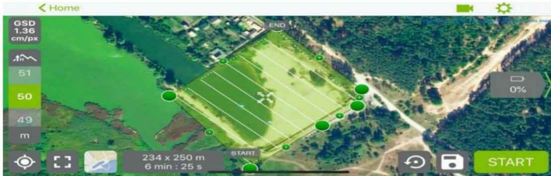
Рис. 4. Вікно планування аерофотозйомки в Pix4DCapture
